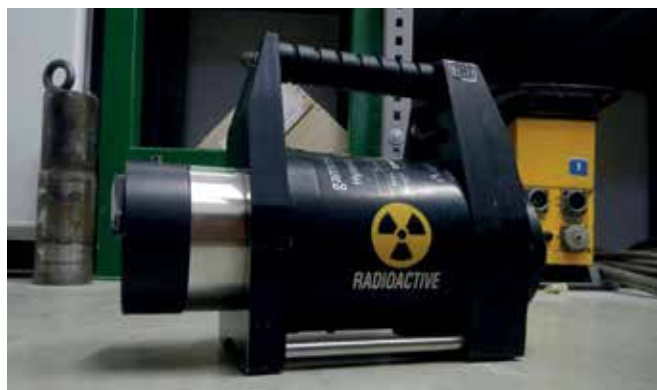
Slika 2: Zaščitni vsebnik z radioaktivnim virom za izvajanje industrijske radiografije.
