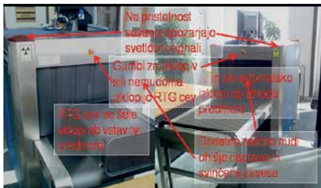
Slika 5: Varnostni sistemi pretočnega RTG.
