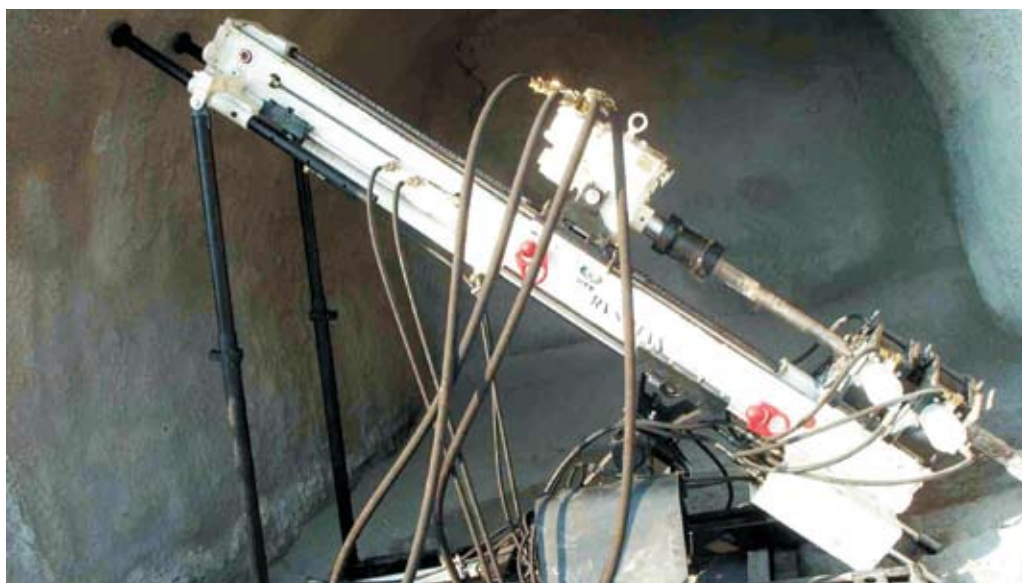
Figure 8. A mast with the rotation head, clamping jaws and the system for fixing the mast Slika 8. Lafeta z rotacijsko glavo, vpenjalnimi čeljustmi ter sistemom za vpetje lafete
