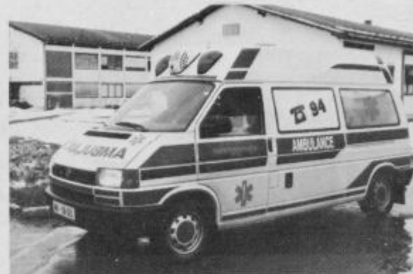
Reševalni avtomobil s povišano streho omogoča lažje oskrbovanje zavarovancev med vožnjo.
