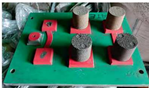
Slika 2. Vzorec modelne plošče, ki jo je zasnovalo podjetje HA ITALIA in je bila proizvedena za projekt.
