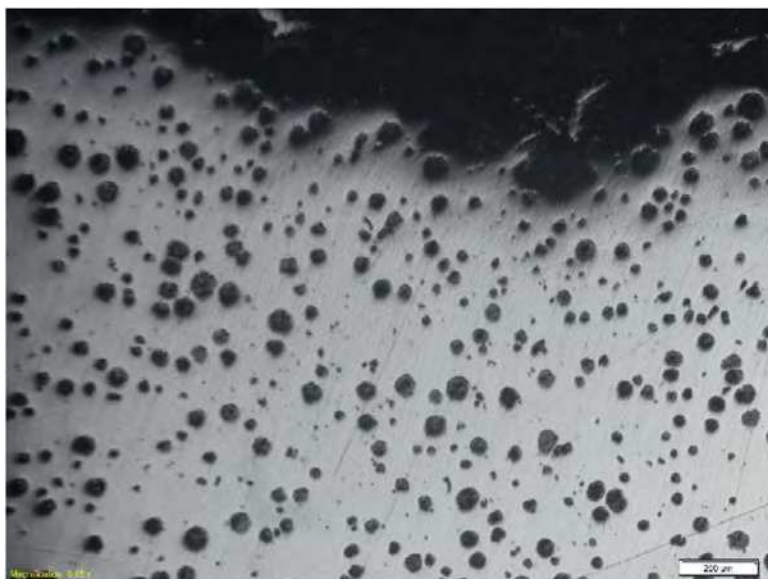
Slika 9. Nejedkana mikrostruktura podpovršinskega območja kocke, ulite z mini napajalnikom CHEMEX T125 (50-kratna povečava).
