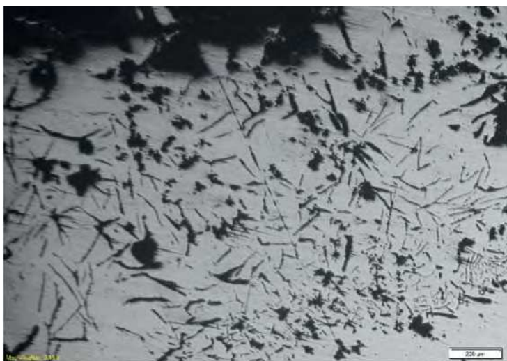
Slika 7. Nejedkana mikrostruktura podpovršinskega območja kocke, ulite z mini napajalnikom FX (vzporedni stožčasti vložni tulec 7/10, proizvajalec 1). Na stičnem območju je vidna lamelasta plast površine ulitka (50-kratna povečava).
