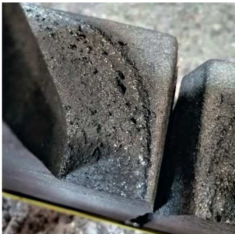
Slika 5. Detajl kocke, ulite z oblogo KX. Na luknjičasti površini so vidni beli nanosi, značilni za napako »ribje oko«.
