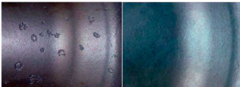
Slika 1. Površina v litem stanju v stiku s formarskim peskom, pripravljenim z ostanki obloge, bogatimi s fluorom (levo); površina v litem stanju v stiku s formarskim peskom, pripravljenim z ostanki obloge brez fluora (desno). Povzeto po [7].
