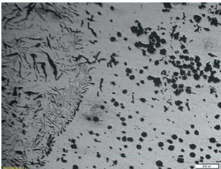
Slika 8. Morfologija grafita vzorcev z mini napajalnikom FX (vzporedni stožčasti vložni tulec 7/10, proizvajalec 1). Po prehodu fronte med formo in kovino se degeneracija nadaljuje do prehodnega območja med lamelnimi in degeneriranimi noduli (50-kratna povečava).
