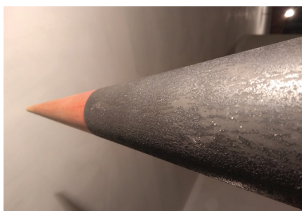
Površina konice po poletu
