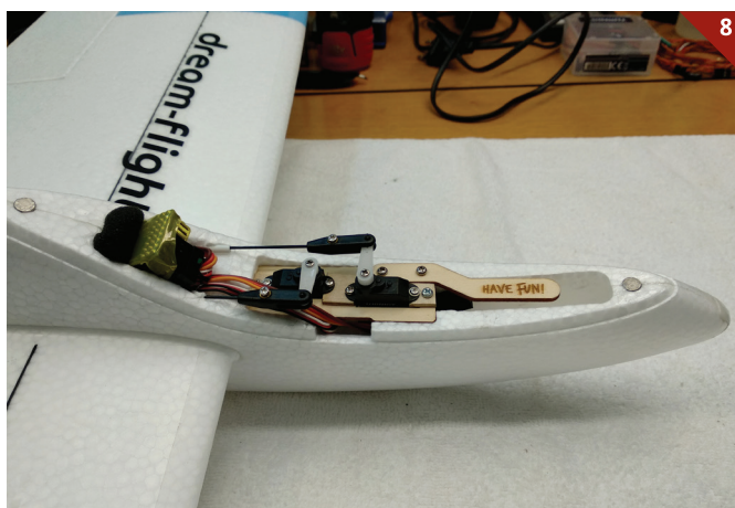
Vgradnja RV-opreme v trupu
