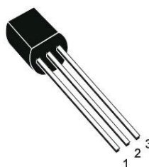
Priključki napetostnega regulatorja LM78L05 (1 – izhod, 2 – GND, 3 – vhod)
