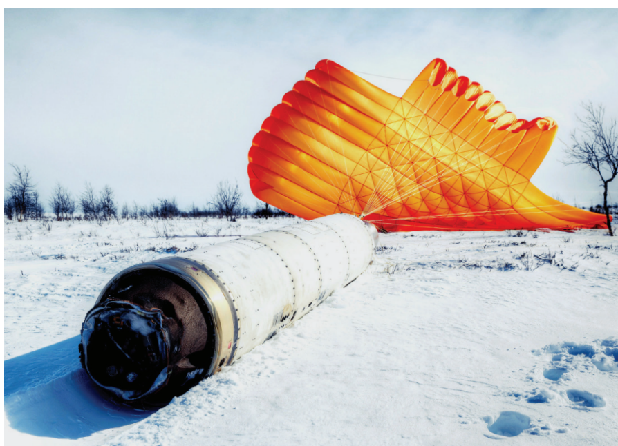
Tovorni odsek s šestimi eksperimentalnimi moduli po varnem pristanku s padalom
