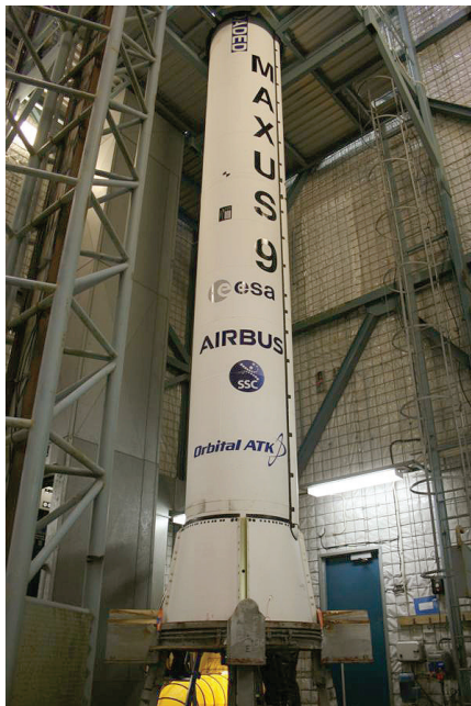
Raketo maxus poganja motor castor 4B z vektorskim krmiljenjem ameriškega proizvajalca Thiokol.
