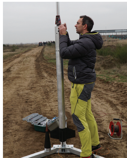
Pred poletom je treba vklopiti vso elektroniko na krovu rakete.
