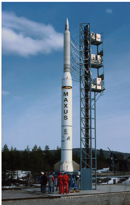
Maxus je najzmogljivejša zahodnoevropska sondažna raketa z vzletno maso 12,4 tone.
