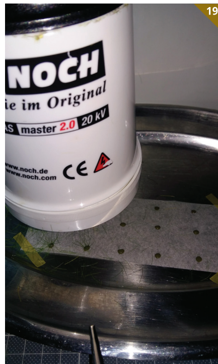
Travo z aplikatorjem nanesemo na kapljice lepila.
