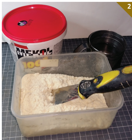
Za premaz zmešamo žaganje, vodo in lepilo.
