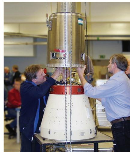
Nameščanje spodnjega dela okrova glave
