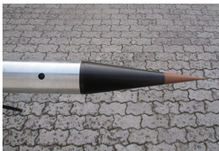
Glava rakete je izdelana iz stekloplastičnega laminata.
