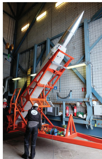
Dviganje tovarnega odseka v navpični položaj
