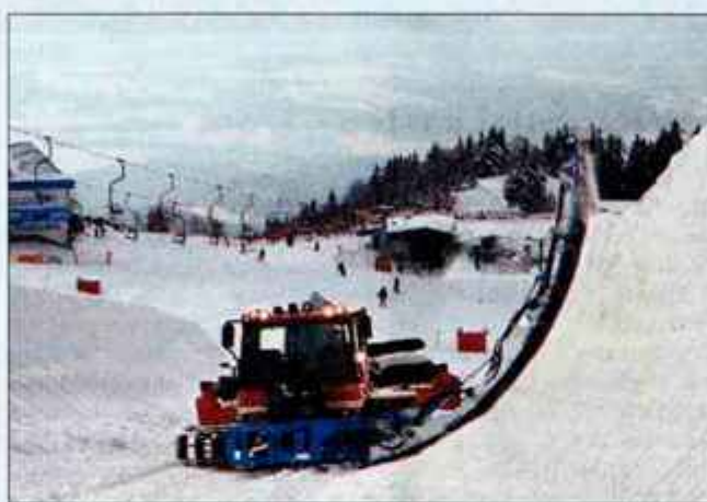
Teptalni stroj z novim orodjem in zmogljivostjo na delu v snežnem žlebu.
