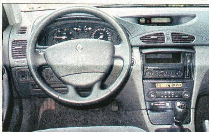
Armatura plošča je pregledna in strogo siva, ključ za odklepanje vrat in zagon motorja je nadomestila magnetna kartica.
