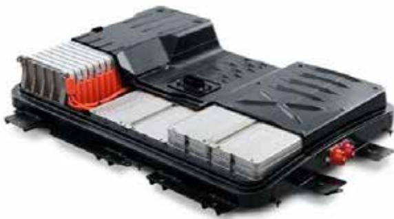
Primer baterije serijskega električnega avtomobila v dnu karoserije
