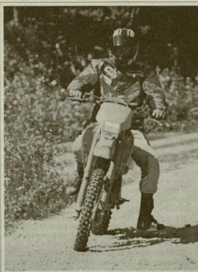
Marzocchi Magnum: kaliber 45 mm, dolžina cevi (hod) 300 mm. Narejen za bojno (tekmovanje) polje.
