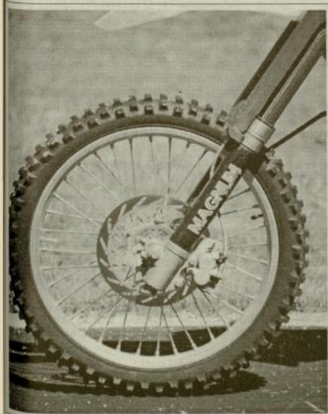
Marzocchi Magnum: kaliber 45 mm, dolžina cevi (hod) 300 mm. Narejen za bojno (tekmovanje) polje.
