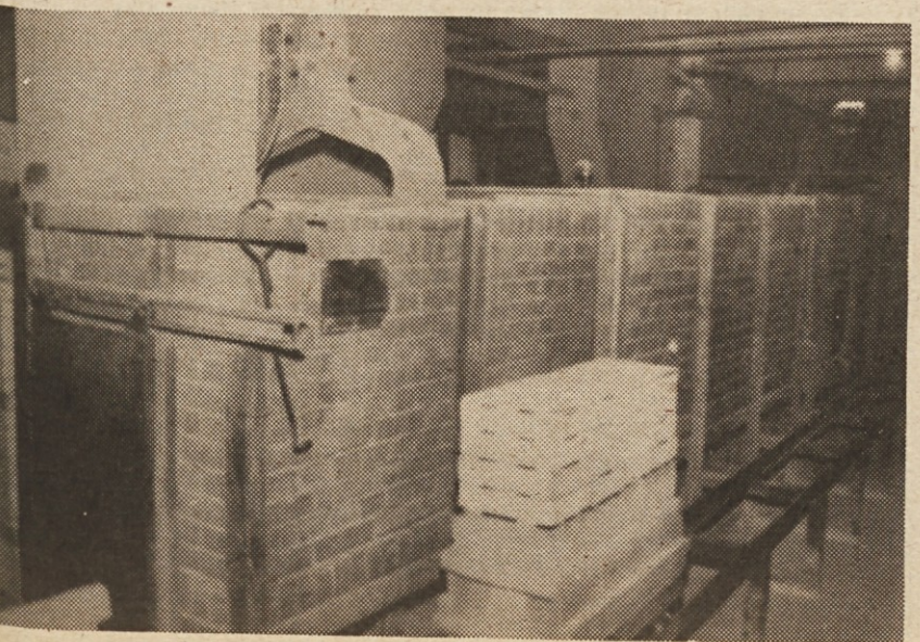
To je dvajset metrov dolga električna tunnelska peč za žganje keramičnih uporovnih teles.
