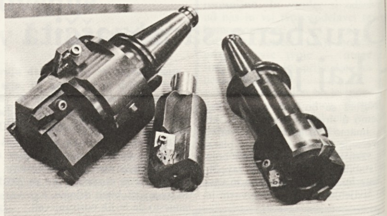
Več rezilno orodje za dodelavo ohišja gonila za vilicar 1/5. S tem orodjem se je skrajšal čas izdelave enega kosa na numerično krmiljenem stroju za dve uri. Ob istočasnem izboljševanju tehnologije, kar je pri sedanjih ceni delovne ure 2.390 din za ta stroj, znaša skupaj prihranek 4.780 din za en kos.
