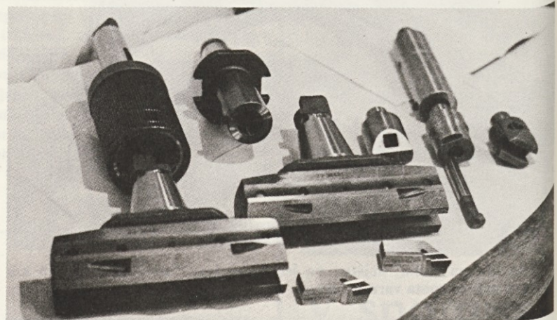
Razen navedenega smo v Litostroju izdelali komplet orodja po Kaiserjevem vzorcu. Tudi ta komplet je zelo uporaben, predvsem za delo na koordinantnih vrtnalnih strojih in vodoravnih vrtnalno frezalnih strojih.
