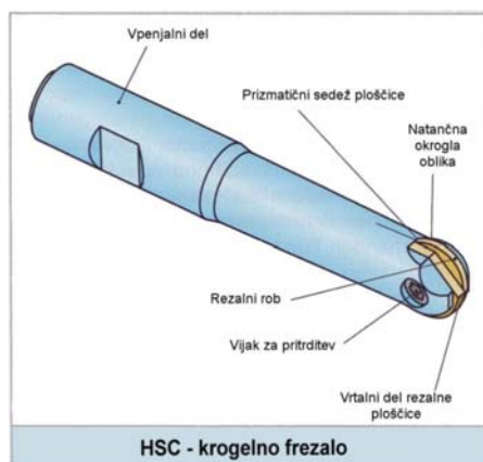
Slika 1: Sodobno oblikovno krogelno frezalo z menjalnimi rezalnimi ploščicami
