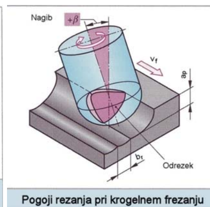
Slika 2: Spreminjanje rezalne hitrosti v odvisnosti od premera orodja
