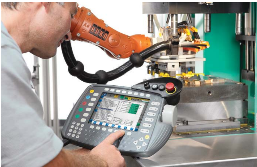
Preprosto programiranje robota s funkcijo »TEACH IN«
