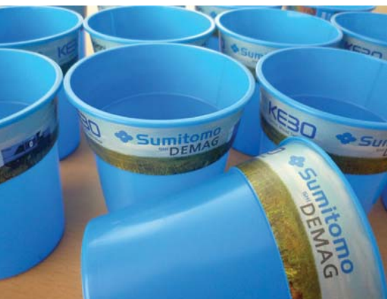
Lonček, izdelan z IML-tehnologijo. Razmerje poti tečenja izdelka na sliki je 1 : 300, čas vbrižgavanja 0,09 s, čas ciklusa 2,66 s, debelina stene 0,3 mm, debelina nalepke pa 0,12 mm.
