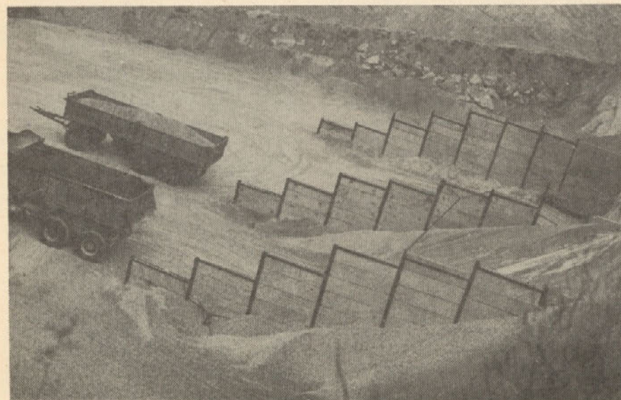
Rampe za nakladanje drobnejših frakcij sejanih peskov v Kamnolomu Paka
