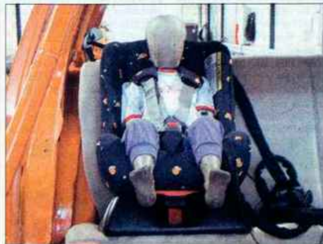
Test je potrdil, da je otroški sedež cam neonato monza nevaren za otroke. - Foto: Motorevija AMZS
