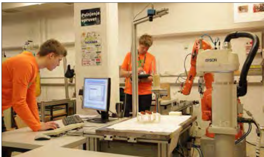
Aplikatorja popravljata še zadnje podrobnosti za robotsko polnjenje in zapiranje epruvet
