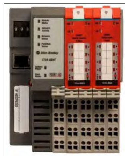
Slika 2. Vhodno-izhodna enota z 8 digitalnimi ali analognimi točkami
