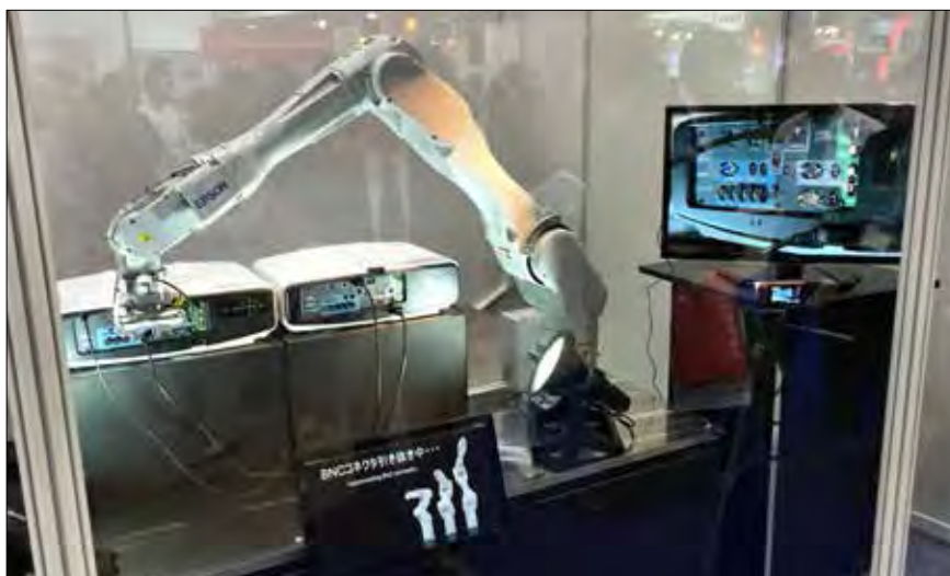
Klasični 6-osni roboti postajajo zaradi napredka tehnologije servomotorjev in vodenja vse vitkejši in okretnejši glede na maso, ki jo prenašajo
