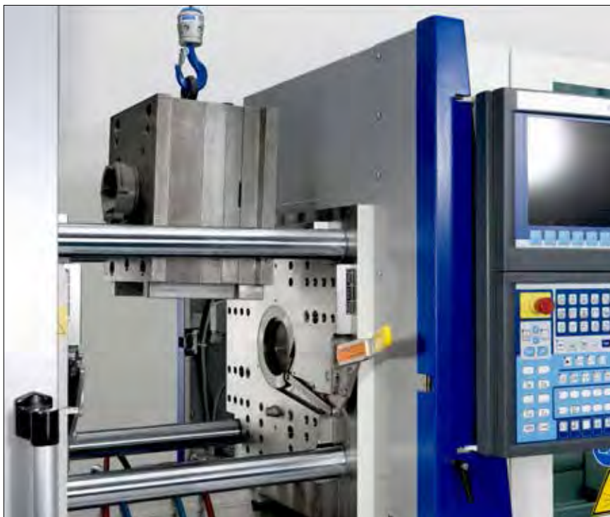
IMM, opremljen s Stäubli QMC (Quick Mould Change) 106 ročnim vpenjalnim sistemom
