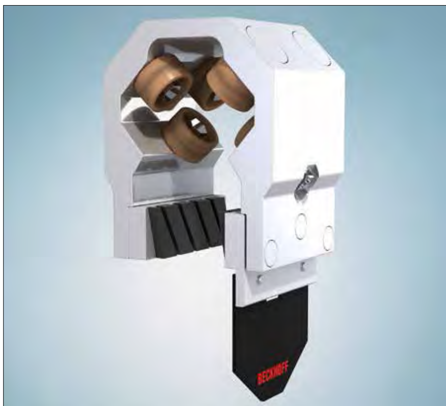
Slika 3. Posebnost sistema XTS je tudi premična enota brez žične povezave
