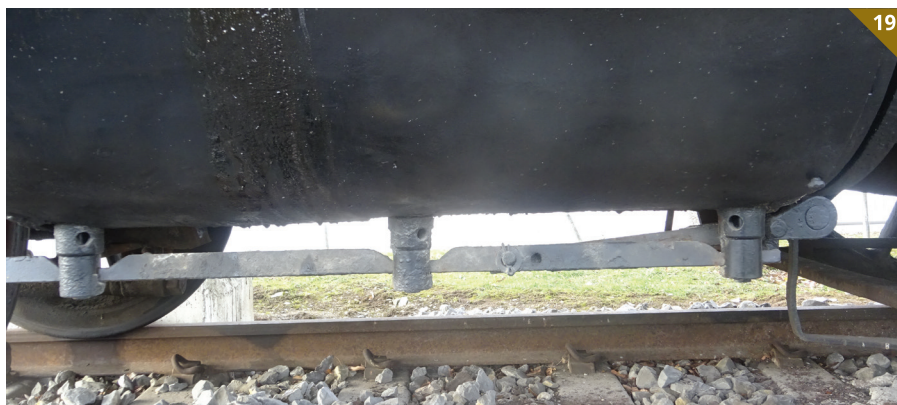
Hene, izpustne pipice za utekočinjeno paro
