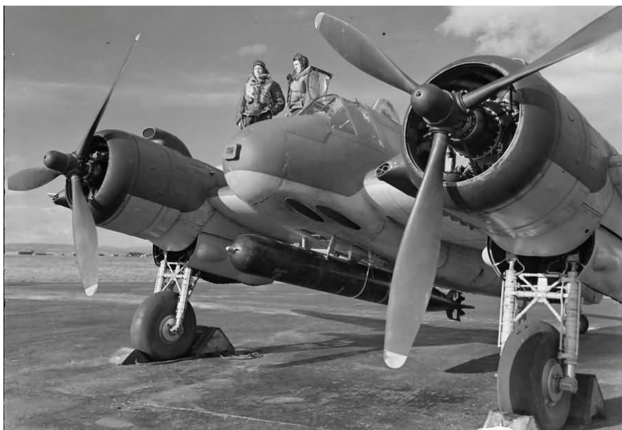
Beaufighter s torpedom (brez dodatnih stabilizacijskih površin). Lepo se vidi oklep na nosu pred vetrobranskim steklom.
