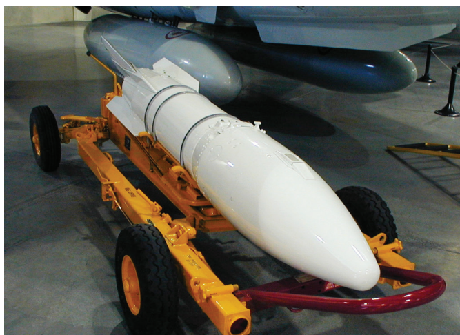
Projektil zrak-zrak MB-1/AIR-2 na transportni prikolicici MF-9
