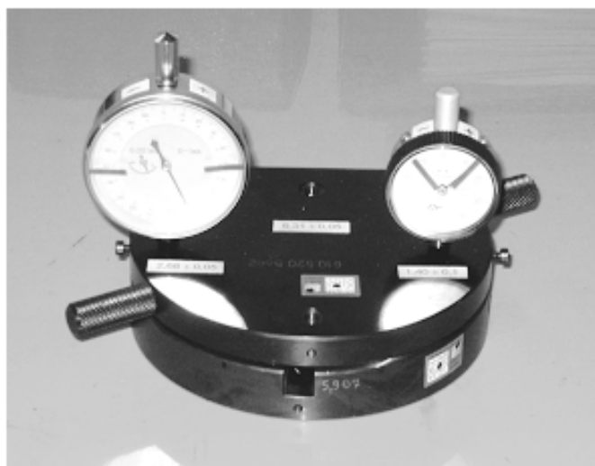
Sl. 4. Merilna naprava za merjenje višine Fig. 4. Height measurement gauge
