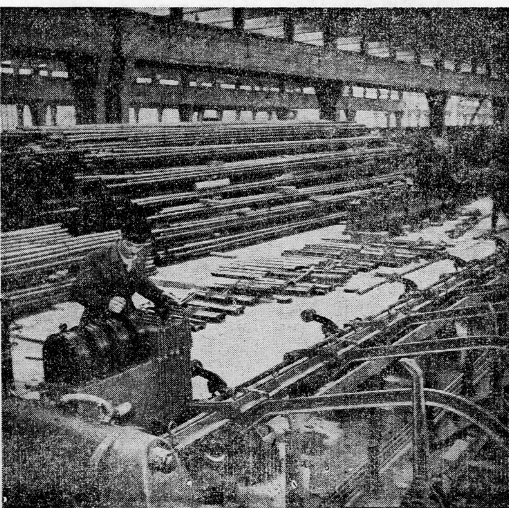
Tovarna jeklenih brežvičnih cevi v Sisku — V ospredju stroj za izdelovanje cevi velikega premera. (Glej članek na 4. strani).
