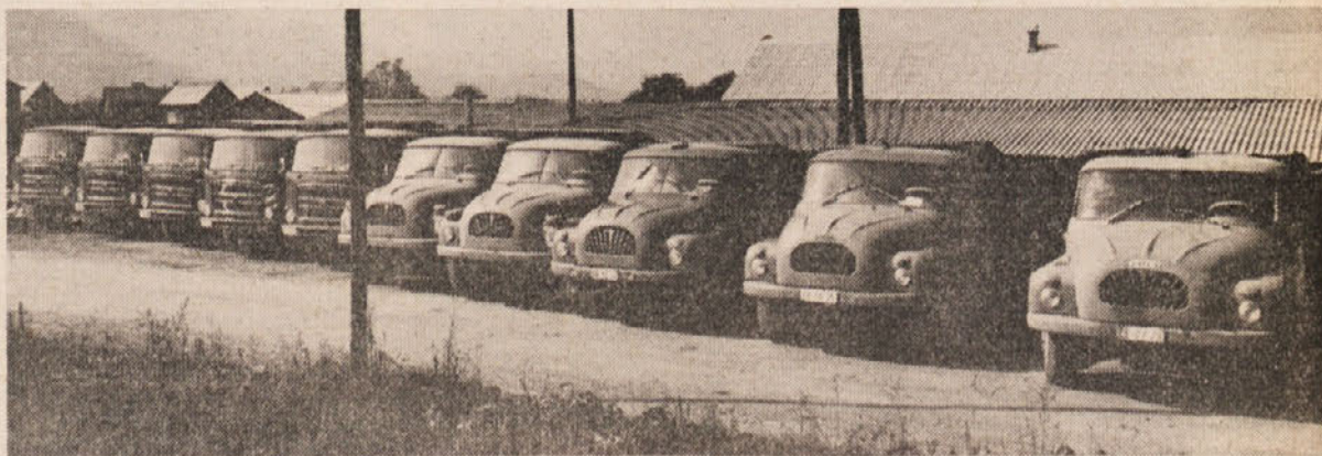
Težki tovornjaki-prekucniki, znamke OM-Titano (nosilnost 18 ton, 305 KS, vlečna sila 54 ton) prevažajo masovne materiale, TATRE-138 (nosilnosti 13 ton, 180 KS) pa uporabljamo za najtežje terenske prevoze (odvozi iz gradbenih jam, izvozi prodca iz Savinje idr.)
