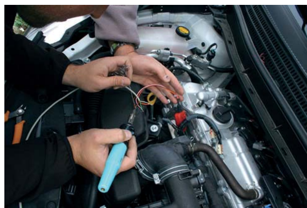
» Pri CVS-Mobile so za uspešno zajemanje podatkov o delovanju hibridnega pogonskega sklopa namestili, kar nekaj dodatnih merilnih elementov.
