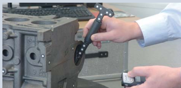
» Slika 6: Merjenje s tipalom za uporabo z ATOS sistemi (vir: scanare3d.com)
