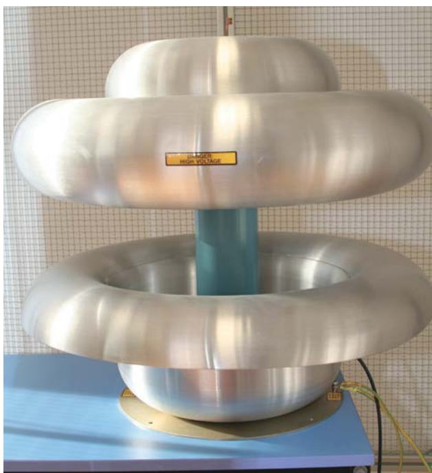
» Sistem za merjenje napetosti (enosmerne napetosti do 120 kV in izmenične do 85 kV)
