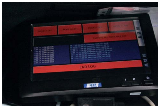
» Pri zajemanju podatkov so strokovnjaki podjetja CVS-Mobile uporabili najbolj dovršene sisteme, ki jih uporabljajo pri vođenju in upravljanju voznih parkov prevoznikov in drugih vozil v poslovne namene. Za zajemanje podatkov delovanja avensisa z dizelskim pogonskim sklopom je bila tako, poleg ostalega uporabljena tudi tehnologija zajemanja podatkov težkih tovornjakov.
