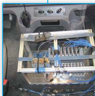
42 ITM uporablja samostojni sistem NI CompactDAQ za preskušanje izpušnih sistemov na tovarnjaku
