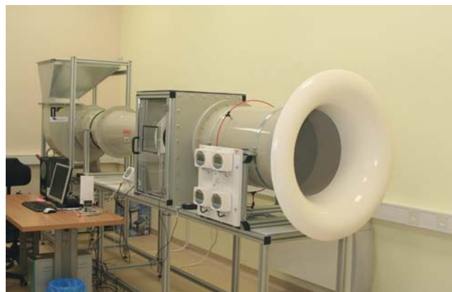
» Vetrni kanal, ki se uporablja za merjenje hitrosti plinov, najpogostejše zraka
