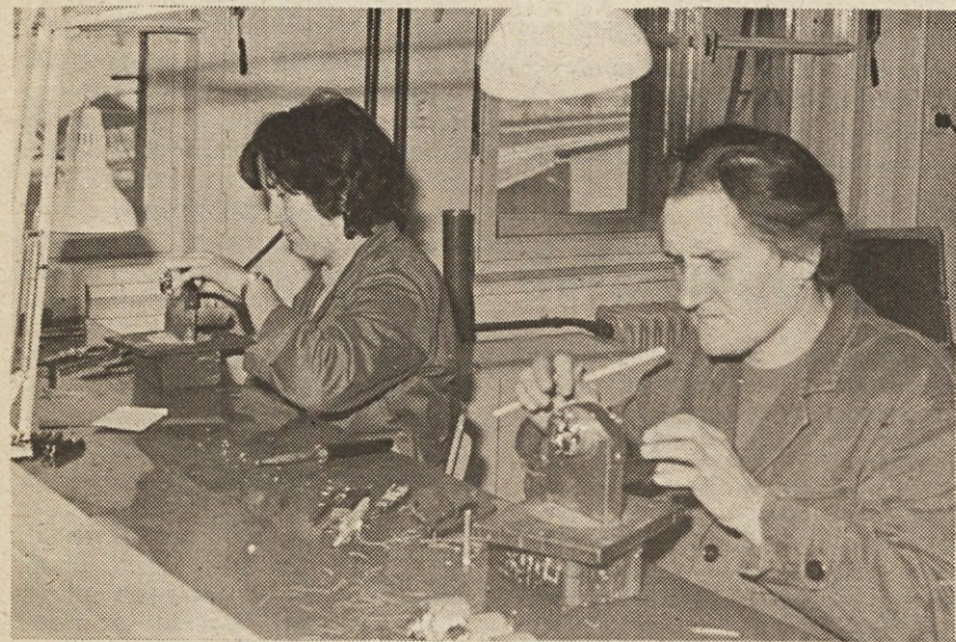
Olga Polajnar in Jožica Starc pri navijanju ter vlaganju navitja za sinhrono.
