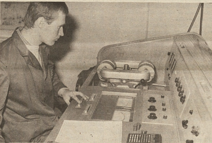
Emil Humar pri merjenju magnetne karakteristike magnetov za ležaje števcov električne energije.
