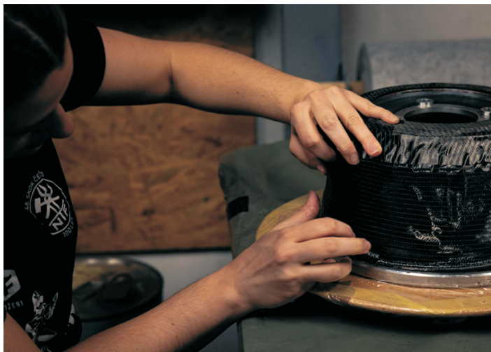
Izdelava platišča z materialom VTC401 CBX245 ± 45 - 42 % RW Foto: Peter Jan
