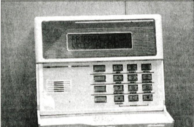
Šifrator za vklop alarmnega sistema
