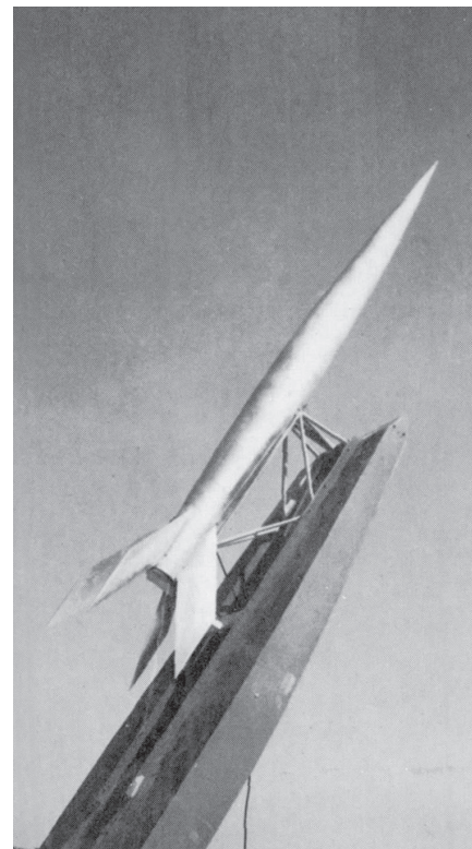
RM-10 v enostopenjski različici pred izstrelitvijo z lanserja nične dolžine na vzletišču Wallops Island
