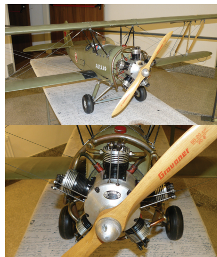
Maketa dvokrilnika polikarpov Po-2, ki jo poganja motor lastne konstrukcije.
