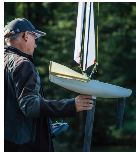
Dodana prostornina na premcu preprečuje potop premca med plovbo z vetrom.
