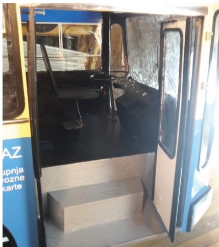
Sprednja vrata se odpirajo s pomočjo servo-mehanizmov.
