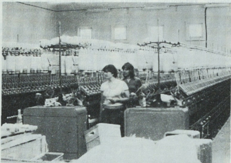
Začasno postavljeni pristančni stroji v novi hali. Izkorišče ni so le eno tretjino, zaradi pomanjkanja predic.
