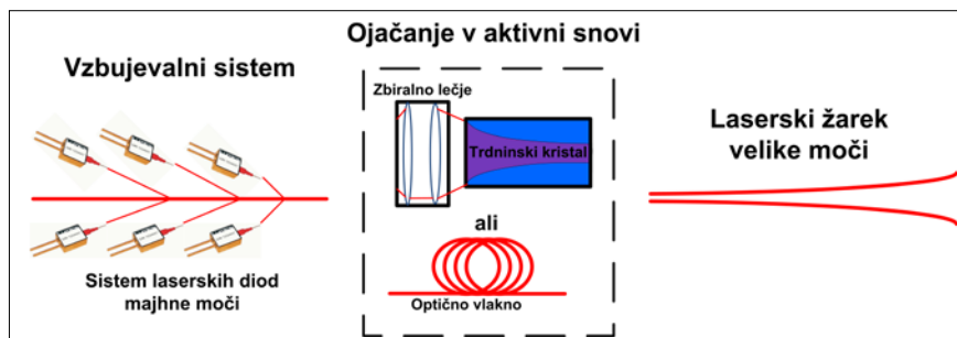
Slika 1. Shema diodno črpanega laserskega sistema velike moči
