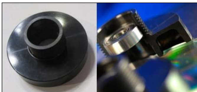
Slika 5. Levo: jermenice po končani operaciji brizganja. Desno: prerez jermenice v vtisnjenim ležajem.
