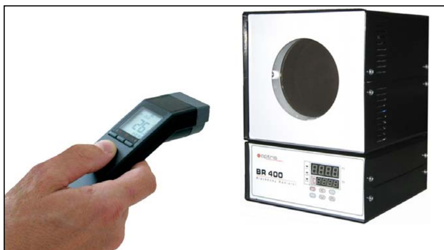
Slika 4. Umerjanje IR-termometra na izvor sevanja, ki je realno črno telo
