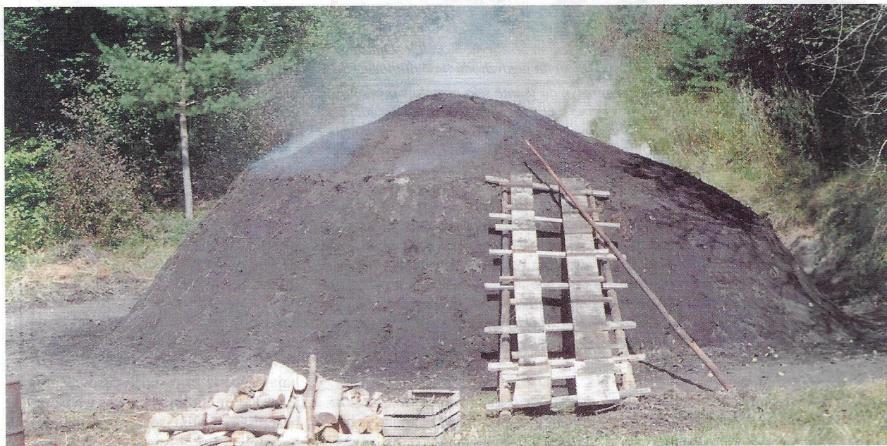
Velika kopa pod Goričico bo tlela kake tri tedne, nato pa jo bodo razdrli in pobrali oglje. Dim in pare nad kopo nastanejo pri tlenju lesa. Ta ne zagori, ker vlažna prst na obodu kope zadržuje izdatnejši dostop kisika iz ozračja. Nekdaj so veliko oglja porabili kovači. Ker kovačev skoraj ni več, naglo izumira tudi oglarska dejavnost.
