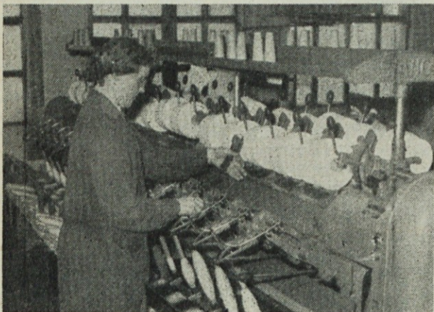
Z novim križno previjalnim strojem »Savio« bomo izboljšali kvaliteto križnih navitkov
