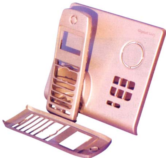
Slika 3: Oblikovana folija za brezžični telefon. Natančen izrez je pri zabrizgavanju folije zelo pomemben.
