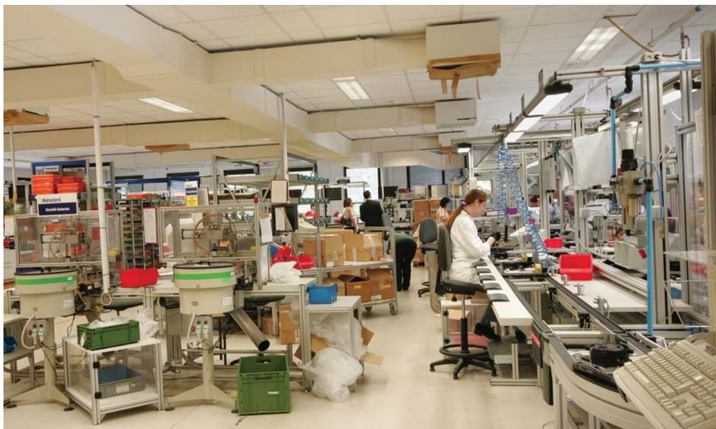
Proizvodnja aktuatorjev za premikanje zunanjih ogledal. Proizvodne linije so bile zasnovane v podjetju, izdelane pa v sodelovanju z zunanjimi izvajalci.
