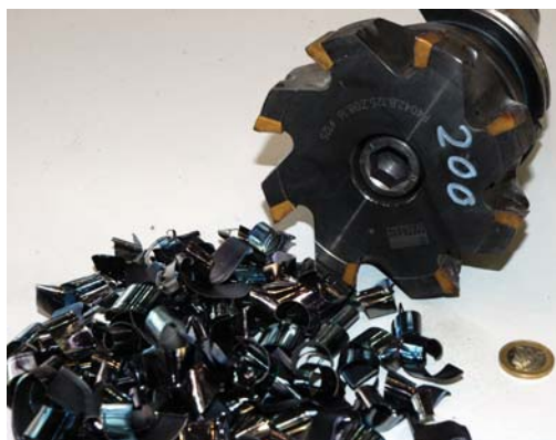
Rezkalnik Xtra.tec F4042 z rombičnimi rezilnimi ploščami za grobo struženje z 18-mm robovi dovaja odlične, razpuščene ostružke v obliki spirale. Dovajanje znaša 12 mm, glede na predizmero lahko globina dovoda niha, pri čemer nastanejo še večji drobci.
