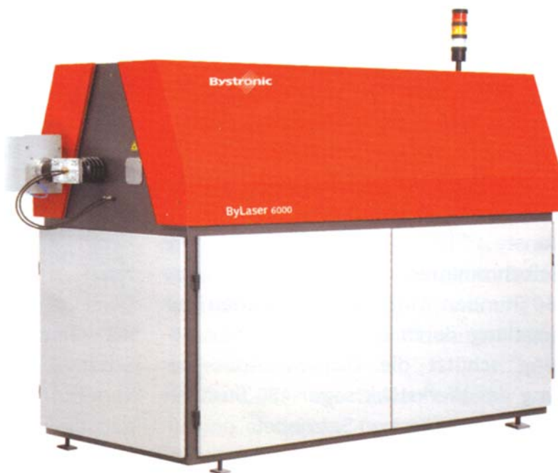
V 6-kilovatnem laserju so pri Bystronicu zamenjali DC-tehnologijo, uporabljeno pri manjših izvorih žarka, s HF-tehnologijo.
