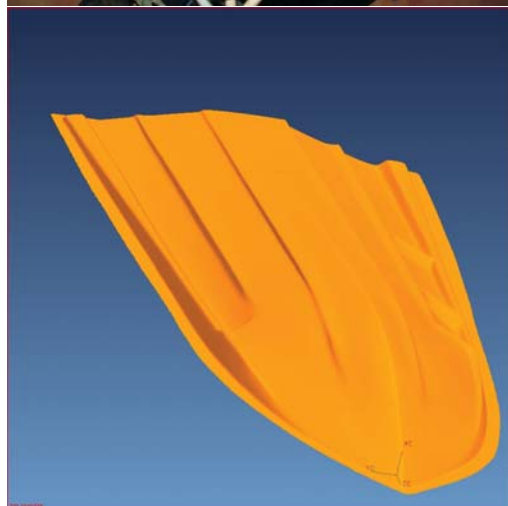
Slika 7: Primerjava med digitaliziranim modelom in idealnim CAD-modelom
