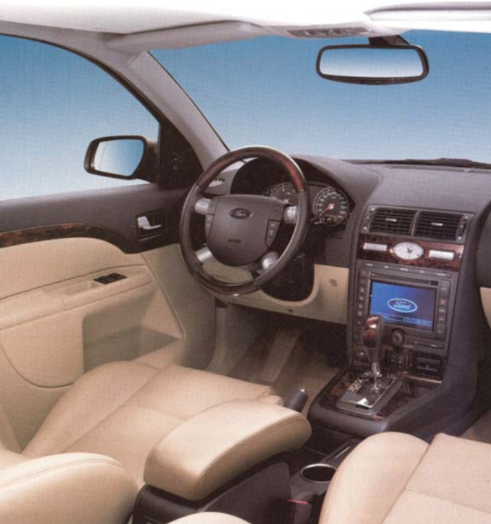
Leseni dekorativni elementi za zlahten videz notranjosti vozila. Elementi iz zabrizgane predoblikovane folije so na tem področju dobro uveljavljeni.
