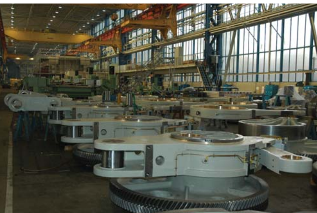
Težka industrija kot iz slikanice: proizvodnja stiskalnic za avtomobilsko industrijo; v ospredju pogonski deli.
