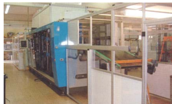
Slika 2: Stroj za termoformiranje, pri katerem postaja za termoformiranje deluje v pogojih čiste sobe. S tem je preprečen dostop nezaželenih delcev do folije.
