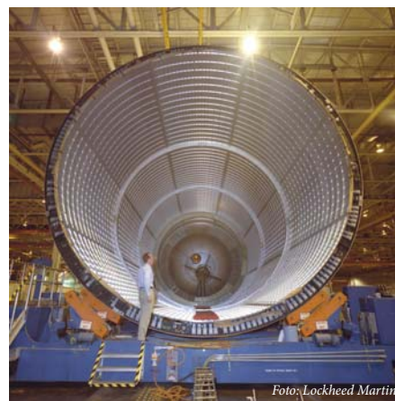
Notranjost rezervoarja s tekočim vodikom med montažo v tovarni Michoud
