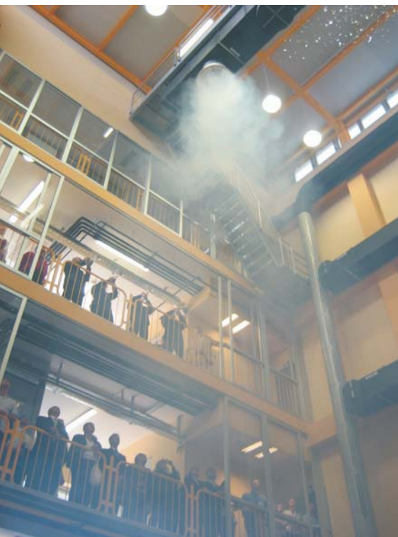
Preizkus z meglo v splošnem laboratoriju, ki vizualno prepričljivo prikazuje delovanje posameznega elementa in je osnova nadaljnjih meritev, je bil tudi primerna otvoritvena gesta.
