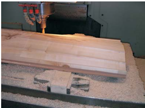
Slika 8: Izdelava lesenega pramodela v orodjarni EMO-TECH
