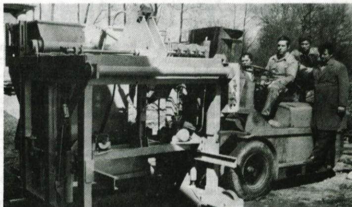
Stroj za izdelovanje betonskih blokov—izdelek ključavničarske delavnice Juhant.
