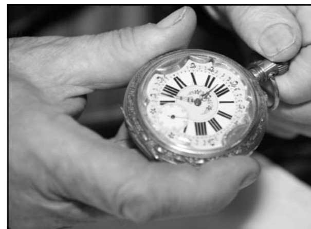
Okoli 150 let stara žepna ura, ki je že delovala z navijanjem na krono. Taki uri so rekli »fantazije ura«, posebna pa je zaradi svoje gravure. V mehanizmu ima petnajst dragih kamnov, rubinov, ki se za razliko od kasnejših medeninastih niso izrabljali. Foto: Aleš Leben.
