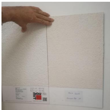
Slika 6: Odstupanje boje fasade.
