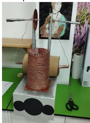
Slika 2. Model Teslina ozonizatora
