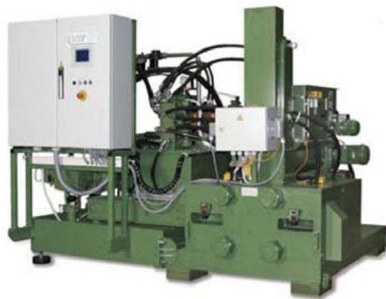
■ RUF-ov stroj za briketiranje lesa RUF 1100. Opremljen je z 55 kW motorjem in omogoča predelavo 1.100 kg/h, odvisno od velikosti iveri. (vse slike foto Ruf GmbH & Co. KG)
