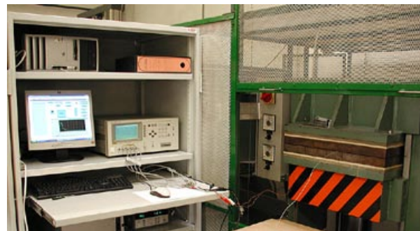
■ Slika 2. Spremljanje utrjevanja lepila v vroči stiskalnici z IDEX senzorjem in LCR metrom
