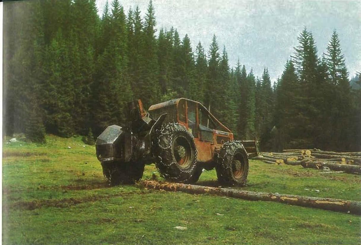
Preskok čez oviro pri frekvenčni analizi vertikalnih vibracij na sedežu zglobnika (foto B. KOŠIR)
