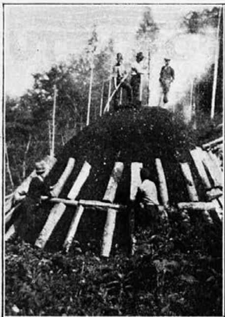
Kopa je gotova in že tudi prižgana. Iz koplčastega črnega gradu se dviga dim, po katerem oglar najbolj sodi, kako kuha napreduje
