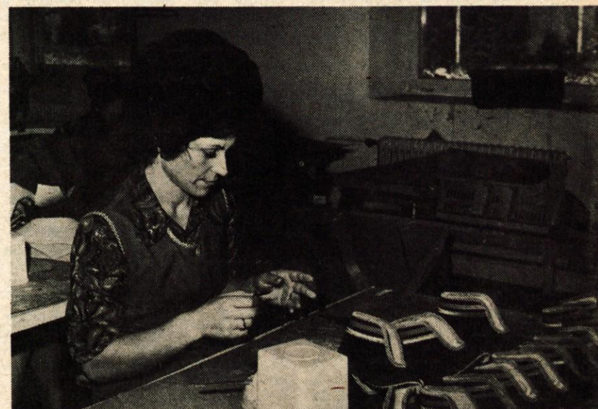
Obrat izdeluje zgornje dele za športno obutev, copate in čevlje iz platna, po tehnološkem postopku »potujejo« proizvođa iz prezovalnice do šivalnice.
