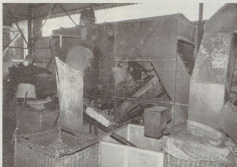
Čistilnike H-12 moramo nujno izboljšati. Posebno še, ker je ročno prebiranje precej nezanesljivo, največkrat pa ga fizično niti ni mogoče obvladati.
