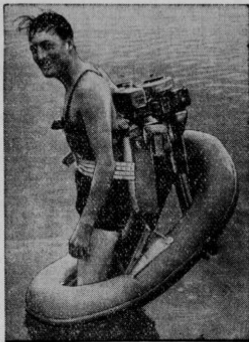
Američan Williams Warren iz Los Angelesa je izumil za morske ponesrečence pripravo, ki je preskrbljena z motorjem. Z njeno pomočjo bo ponesrečenec lahko plaval z brzino nekaj milj na uro.
