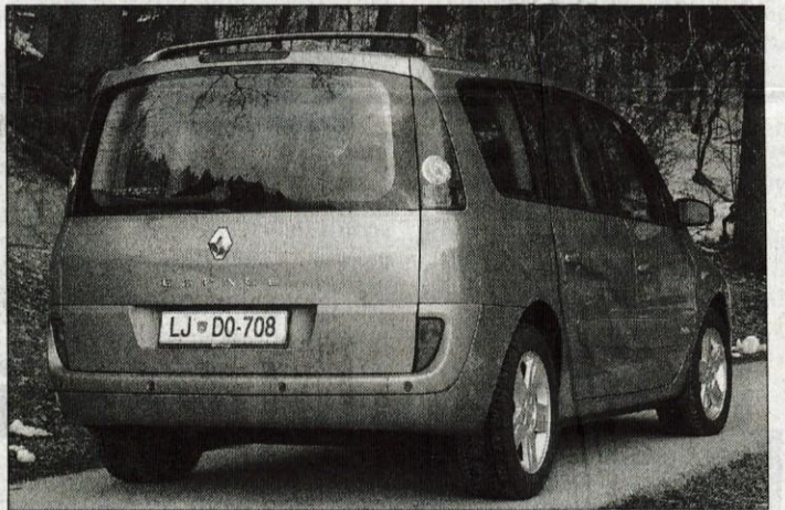
Kombijevsko ravno odrezan zadnji del: prtljažna vrata zarezana v odbijač in luči v strešnih stebričkih.
