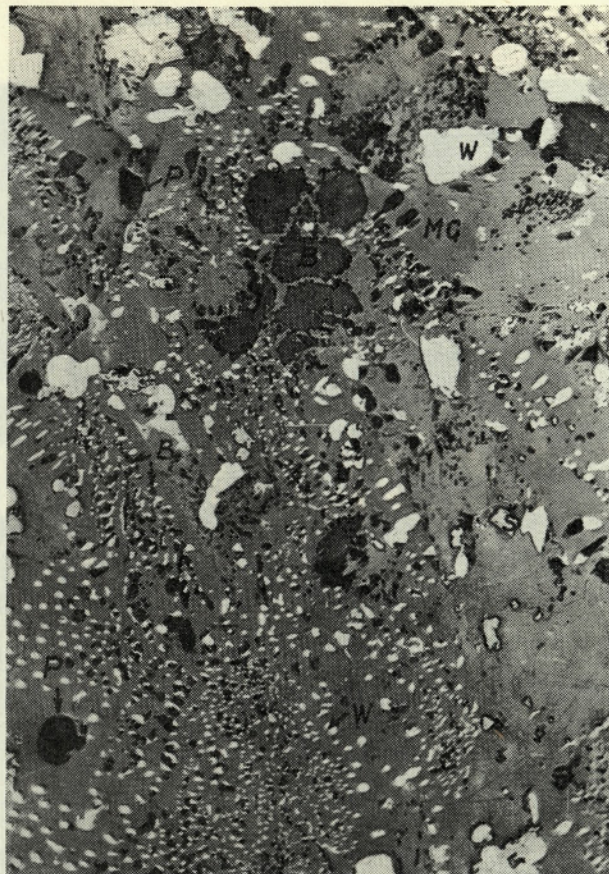
Slika 4. Vzorec: žlindra EL-3, šarža 7232. Obrus, povečava 190 X, jedkano z \text{NH}_4\text{Cl} . Vidna so zelo drobna, redko malo večja zrna belita (B), zrna wüstita (W), zrna špinela (Š) pore (p) montičelit in gehlenit (MG)
