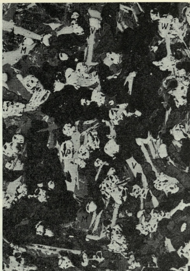
Slika 5. Vzorec: žlindra EL-4, šarža EA 296. Obrus, povečava 190 ×, jedkano z \text{NH}_4\text{Cl} .
