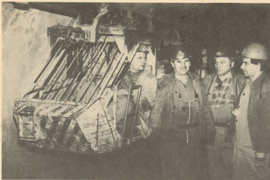
Pri scharfu (vlakcu za transport jamskega materiala in opreme po viseči tračni progi z dieselsko lokomotivo) na ranžirni postaji na koti – 47 severnega predela jame Preloge – s strojnikom Karlom Blazinškom (tretji z desne strani)
