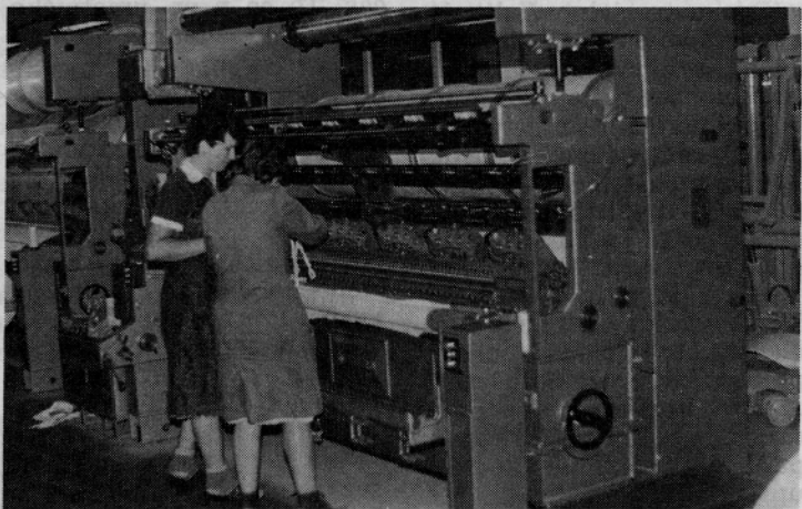
Snutkovni pletilni stroj Kokett U4 — priprava stroja za obratovanje.
