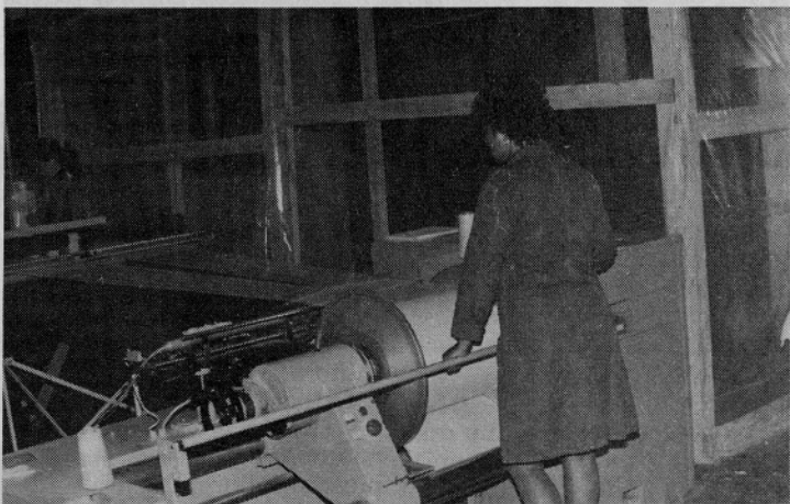
Kvalitetno snovanje na sekcionalnem snovalu je predpogoj za nemoteno delovanje pletilnice.
