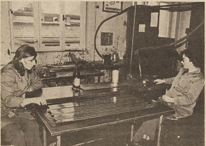
Anica Pirnar in Cvetka Luzar nanašata uporovno maso na drsne obročke potenciometrov.
