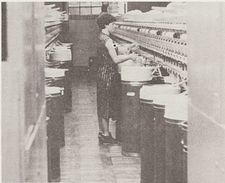
Delavka veže pretrgano nit na brezvretenskem predilnem stroju.
