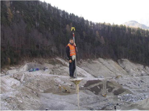
Slika 4: Geodetske meritve na plazu Stože novembra 2005 (foto: Matjaž Mikoš).
