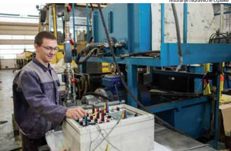
Testiranje hidravlične črpalke
