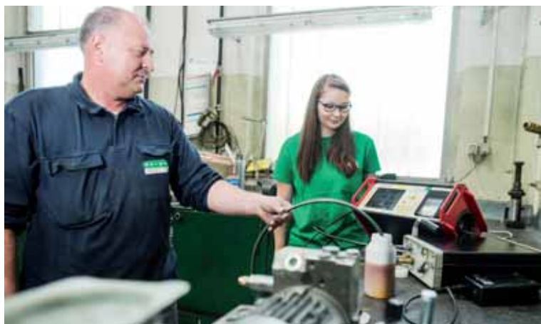
Meritve kontaminacije hidravličnega fluida s trdnimi delci
