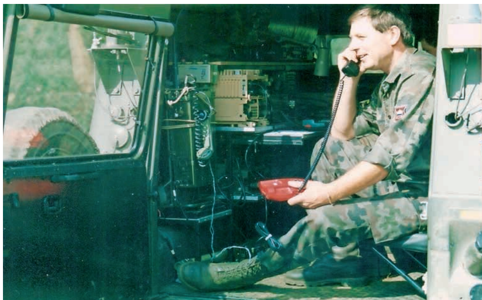
Vozilo za zveze Puch 230 GE4 z vgrajeno radijsko postajo BCC-66HE z ojačevalcem in vezistom pri poročanju (foto arhiv: Tomaž Lavtižar)
