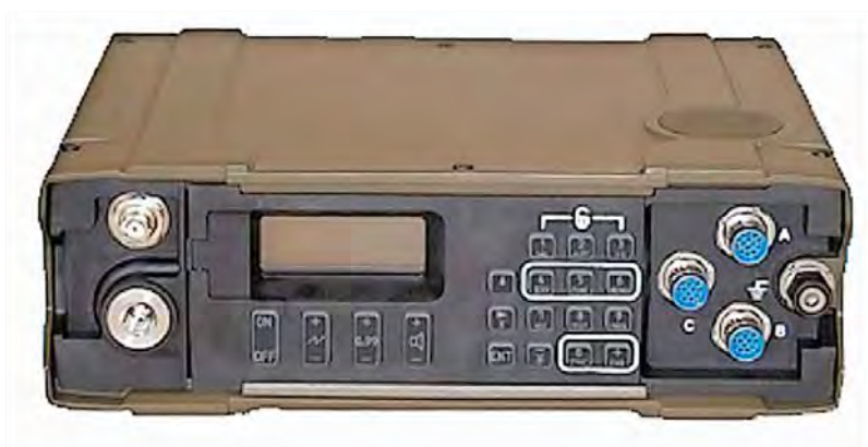
HF-radijska naprava TRC-3700 (foto arhiv: GŠSV)
