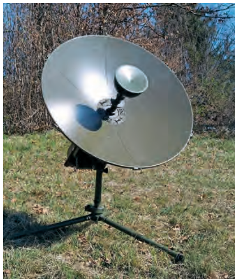
SHF-X satelitski terminal Selex TST101/X (foto arhiv: GŠSV)
