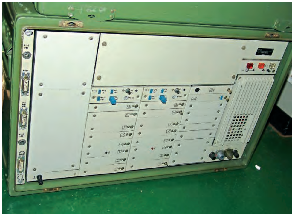
VF-analogni sistem VZ-12 K Iskra v Natovem kovčku, ki je omogočal 12 telefonskih ali telegrafskih zvez prek posebnih 2- ali 4-žičnih vilic. (foto: Jernej Bizjak)
