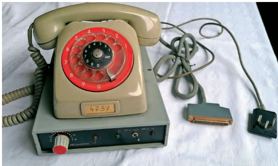
Aparat specialnega telefonskega omrežja z dodano zaščitno napravo (foto arhiv: Igor Makuc)
