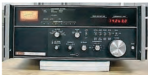
Profesionalna radio-prislušna sprejemnika Collins 851S-1 (levo) in starejša različica Collins 51S-1 (desno), ZDA, uporabljena za spremljanje radijskega prometa enot JLA (vir: http://www.rigpix.com/collins/collins_851s1.htm in https://deluxelasopa301.weebly.com/collins-51s-1-serial-numbers.html )
