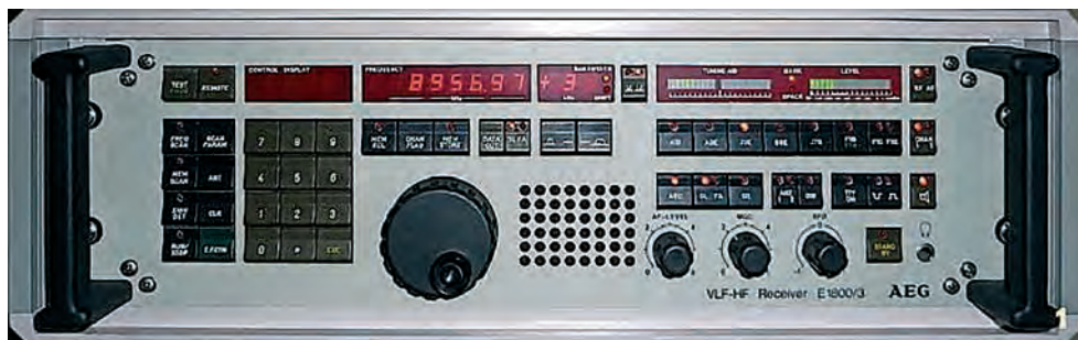
Profesionalni radio-prislušni sprejemnik AEG Telefunken E 1800/3, Nemčija, uporabljen za spremljanje telefonskih pogovorov v večkanalnih radiorelejnih zvezah JLA (vir: http://www.seefunknetz.de/e1800_3.htm )
