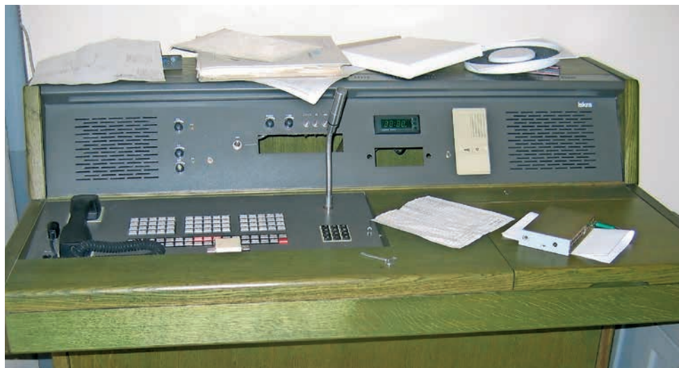
Posredovalna miza KU-60 Iskra je bila elektronska in je zamenjala stare induktorske posredovalne naprave. Zmogljivost zvez je bila 60 priključkov, neodvisno od režima prenosa (dvo- ali štirižično). (foto: Marjan Kleva)
