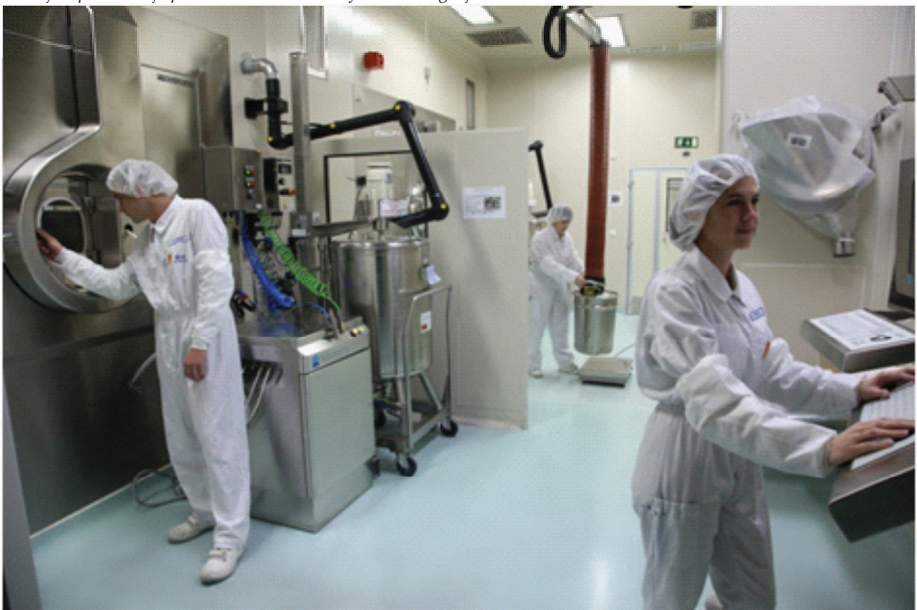
Prevalje – proizvodnja penicilinskih izdelkov – filmsko oblaganje tablet
