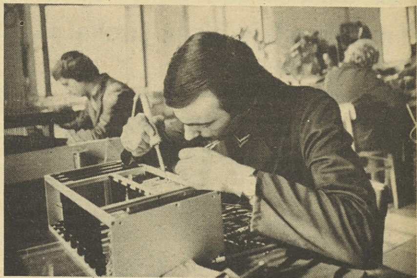
Montaža elektronskih komponent za merilne naprave.
