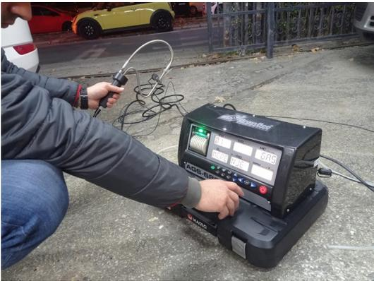
**Figure 4:** BrainBee AGS 688 Gas Analyzer
